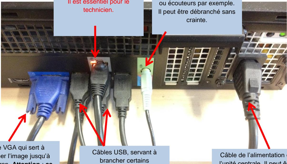
Câble VGA qui sert à emmener l'image jusqu'à votre écran. **Attention : ce câble possède deux petites vis qui doivent impérativement être dévissées avant de tirer sur l'embout.**
